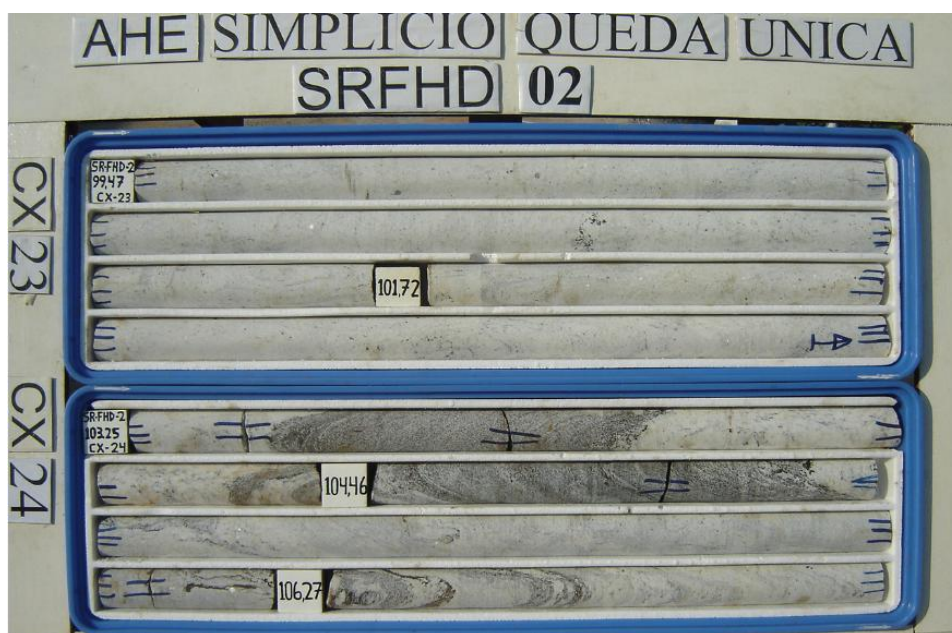
Figura 18 - Caixa de testemunhos da SR-02 nas profundidades correspondentes as anomalias observadas nos ensaios de Armelin et al. (2008)
