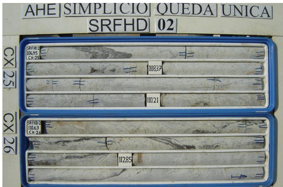
Figura 19 - Caixa de testemunhos da SR-02 nas profundidades correspondentes as anomalias observadas nos ensaios de Armelin et al. (2008)
